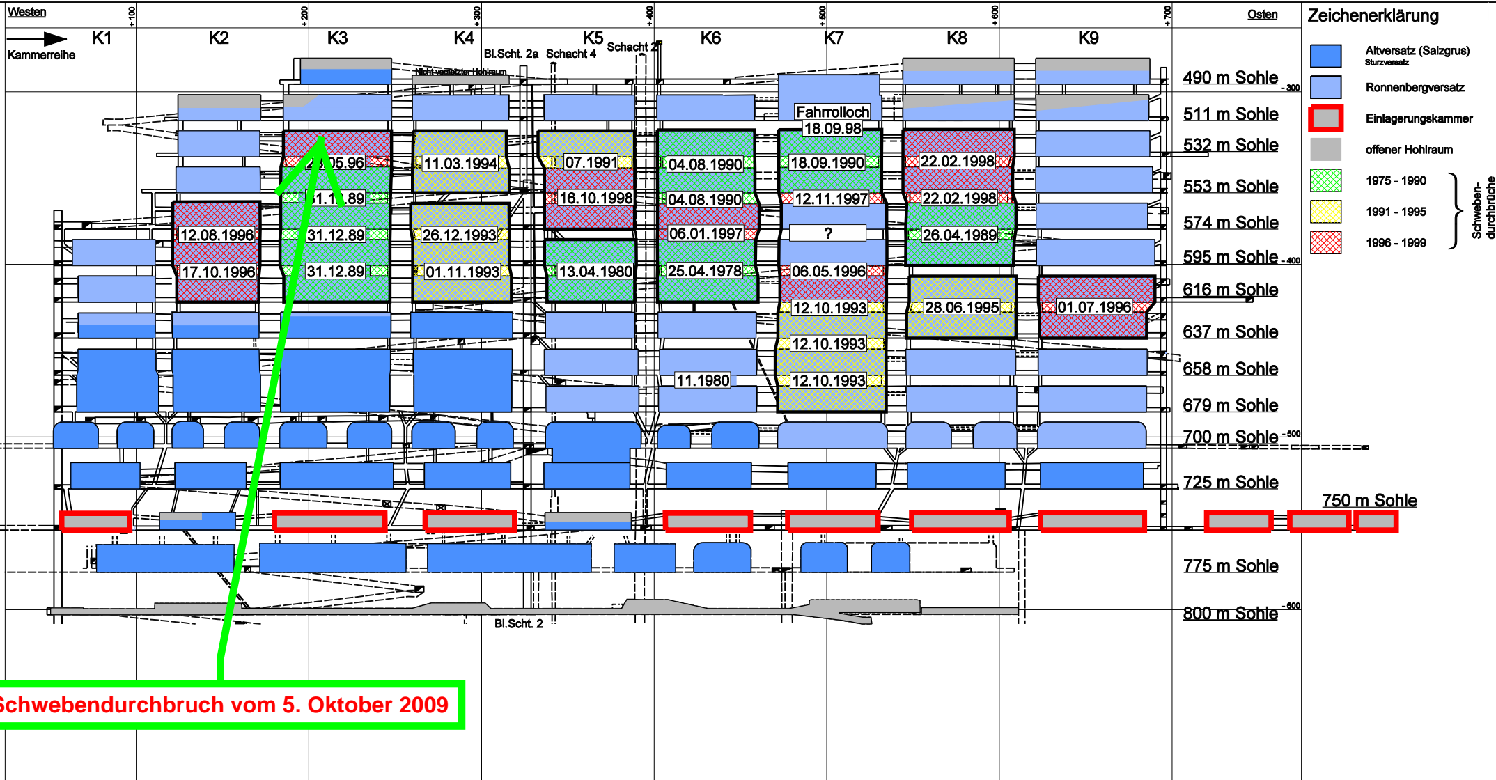
Schachtanlage Asse vereinfachter Seigerriß u. Längsschnitt ①
